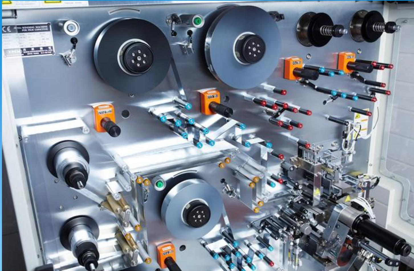
La qualité d'un condensateur bobiné est intimement liée à l'opération de bobinage. Lors de laquelle aucun à-coup, dû à une différence de vitesse ou d'accélération ou décélération, ne doit se produire.
