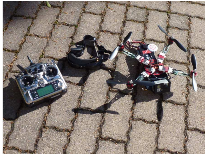
MC-Drone, camera HD, vidéo embarquée, GPS, Casque pour vue à distance
