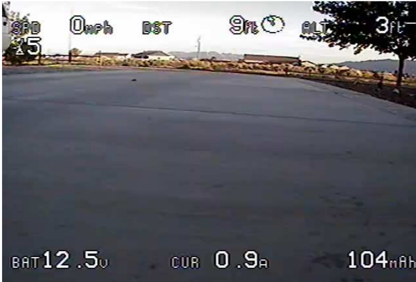
OSD On-Screen-Display Incrustation d'information dans le signal video
